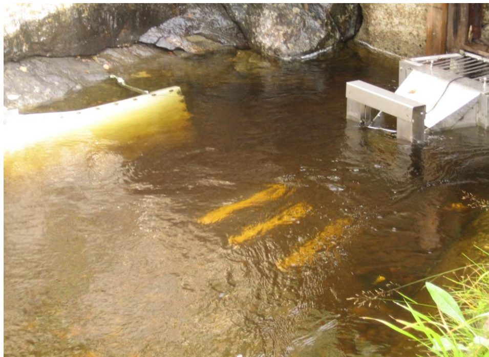
Figur 3. Fisketellerens plassering i trappa i Berrefossen. Lengdemålingene av fisk kalibreres mot tre målestaver som ligger på bunnen i forkant av telleren.
