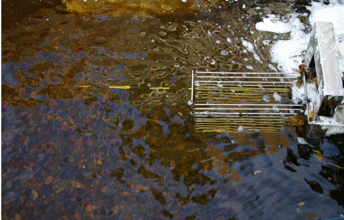
Figur 2. Fisketellerens plassering i trappa i Berrefossen. Lengden på fisken måles mot målestaven montert på kalven som står i forlengelsen av selve tellemekanismen.
