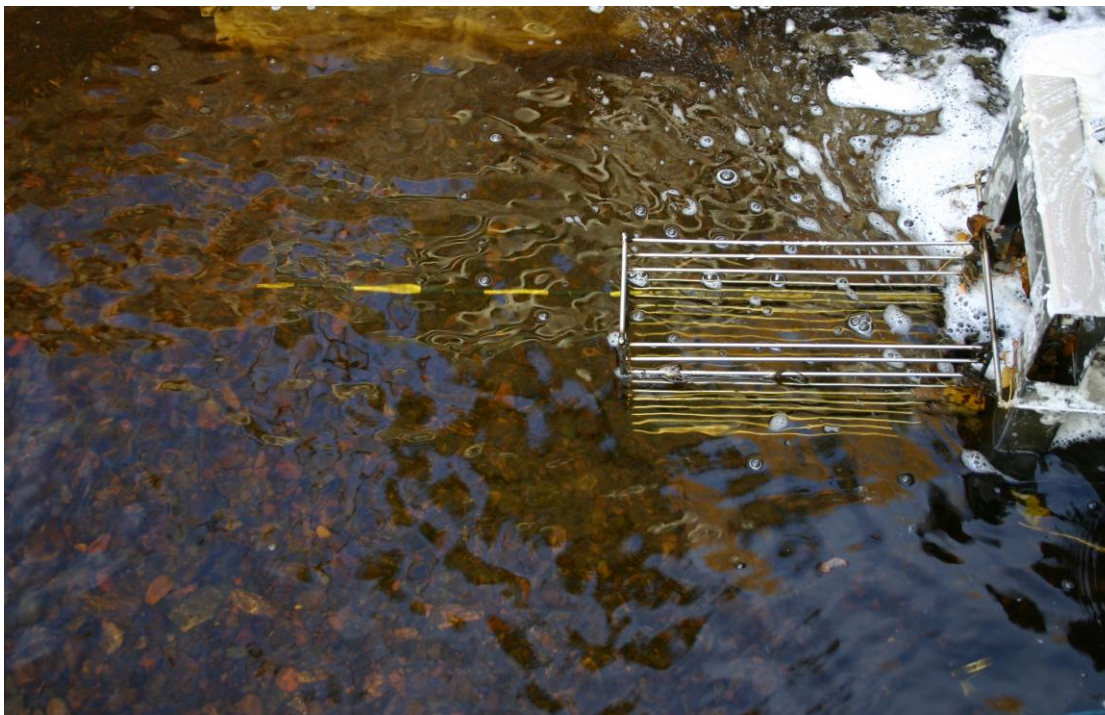
Figur 2. Fisketelleren i trappa i Berrefossen. Lengden på fisken måles mot målestaven montert på kalven som står i forlengelse av selve tellemekanismen.
