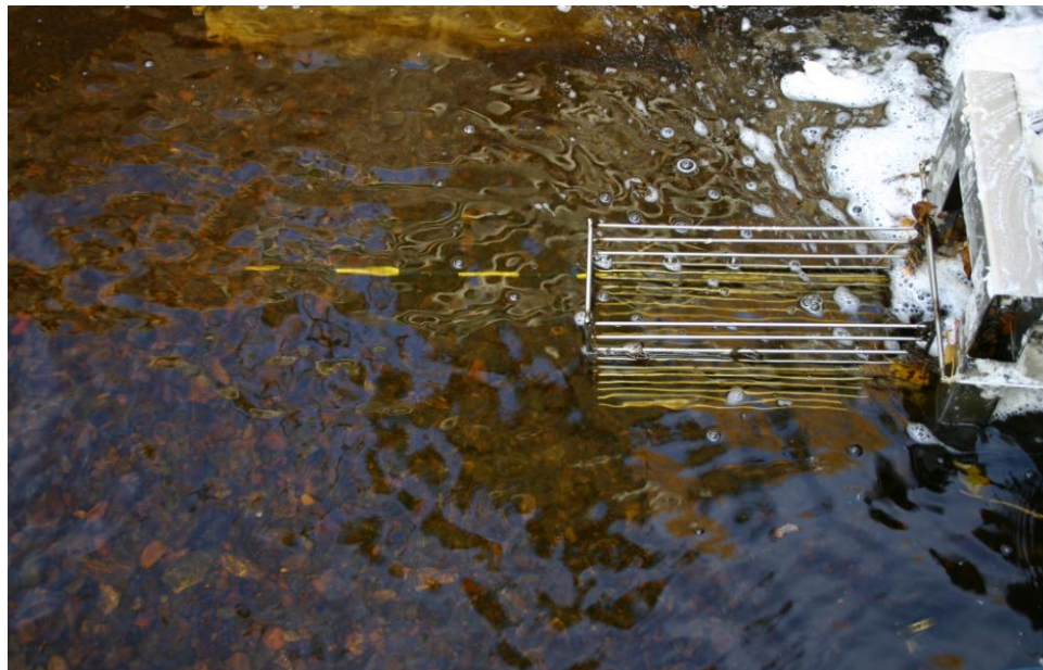
Figur 1. Fisketelleren i trappa i Berrefossen. Lengden på fisken måles mot målestaven montert på kalven som står i forlengelse av selve tellemekanismen (Foto: Tomas Sandnes).
